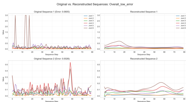
รูปที่ 9 กราฟก่อนและหลังใช้งานโมเดล LSTM Autoencoder ของทุกประเภทงานที่มีค่าการเคลื่อนไหวต่ำ
